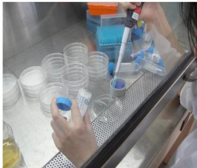
圖二十九 取各稀釋倍數之檢液 1ML 置入無菌培養皿內(自行拍攝)
