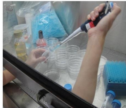
圖二十八 自試管中抽取 1ML 放入另一個 9ML 之試管中進行稀釋(自行拍攝)
