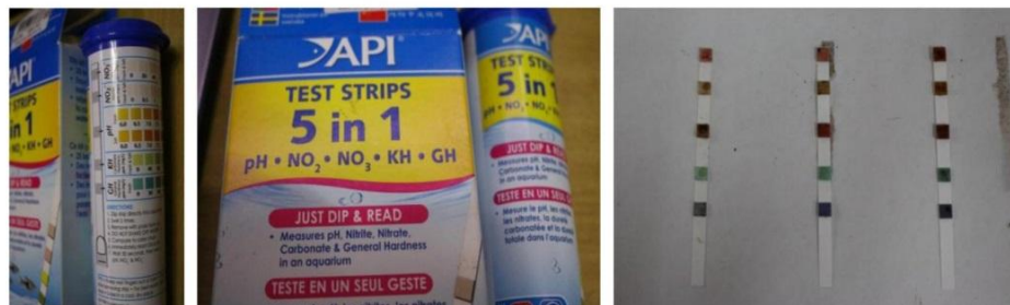
圖 8、腐植土(植食性清除者土肥)酸鹼值的測量步驟 A：秤取適量腐植土(植食性清除者土肥)，B：加入適量的蒸餾水並以果汁機打碎，C：將打碎的腐植土(植食性清除者土肥)液倒至燒杯，靜置後以試紙 API 五合一試紙測試 \text{NO}_3^- , \text{NO}_2^- , \text{CO}_3^- 及酸鹼值(pH)。
